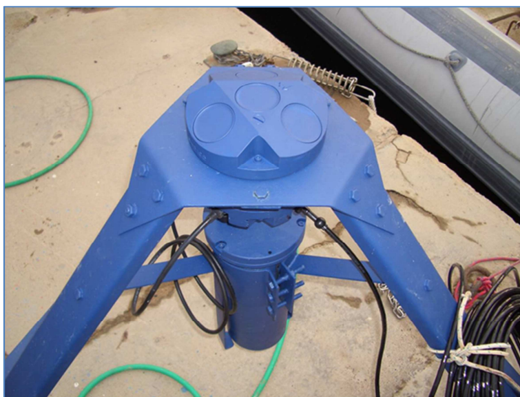
Figura 04: Vista dell'AWAC prima dell'installazione con l'antivegetativa blu
