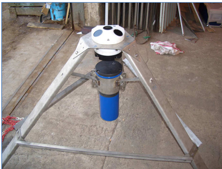
Figura 03: Vista del sistema AWAC nell'apposito traliccio in acciaio inox
